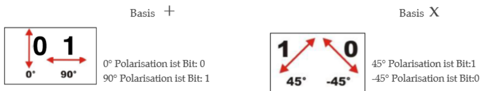
Abbildung 43: Basen, in denen Bits gesendet werden können - Quantenkryptographie
